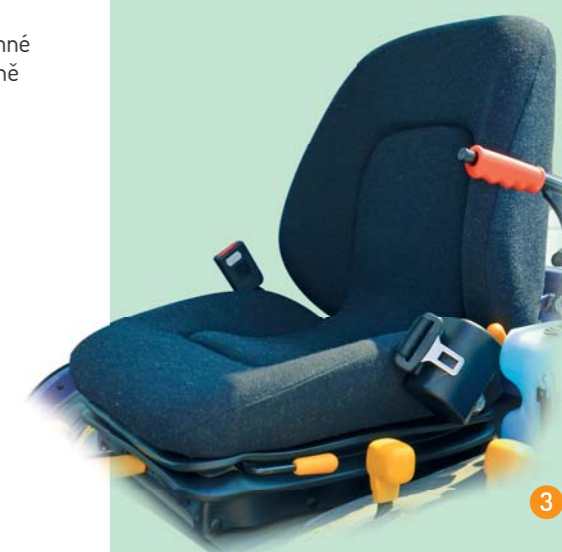
Ergonomické komfortní sedadlo řidiče s možností vícenásobného nastavení polohy opěradla, vodorovné polohy sedadla a polohy sklonu a výšky.
