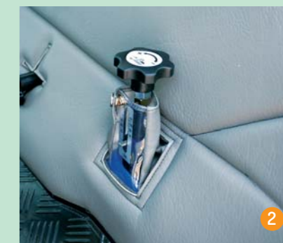
Nastavení výšky sečení žacího ústrojí uvnitř kabiny
