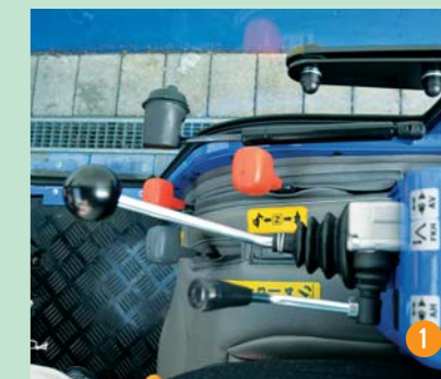
Joystick pro ovládání všech hydraulických funkcí
