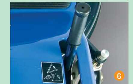
Páka pro ovládání čistící klapy výhozového tunelu v přímém dosahu obsluhy.
