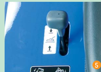
Ovládací páka pro zdvih kosy (vlevo) a pro zvedání koše (vysypání z výšky, foto vpravo).
