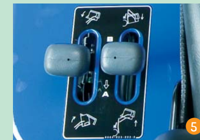
Ovládací páka pro zdvih kosy (vlevo) a pro zvedání koše (vysypání z výšky, foto vpravo).
