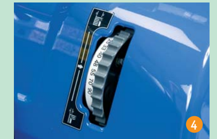
Rychlé nastavení výšky žacího ústrojí v 6 stupních: 25, 33, 40, 48, 55, 70 a 90 mm.
