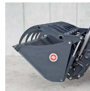
2 Zaklopení nářadí – zajišťovací mechanismus se automaticky zacvakne
