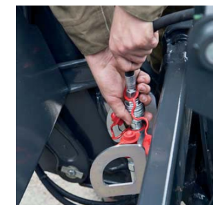
3 Zapojení hydraulického vedení
