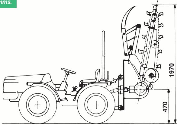
Attrezzo per l'esecuzione di trincee su materiale vegetale compatto. Il gruppo di scavo viene montato sul sollevatore con attacco a tre punti ed azionato dalla presa di forza a 540 giri/min di qualsiasi trattore da 30-60 cv in grado di consentire una velocità di circa 300 m/h con motore a regime.
