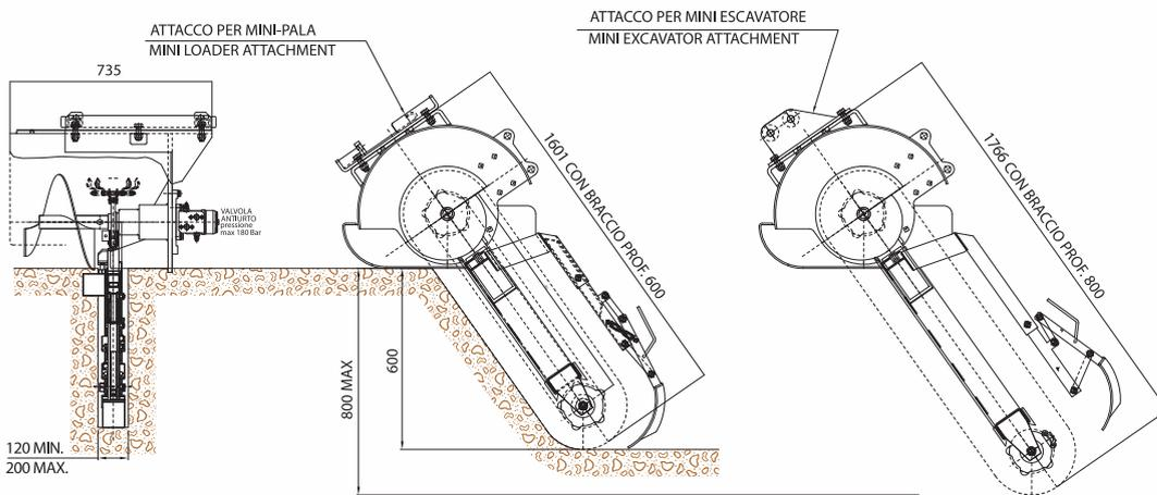
Applicazione per minipala o miniescavatore in grado di erogare all'utensile di scavo almeno 35-45 litri al minuto ad una pressione di 150-175 bar.
