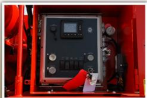
Integrovaný řídicí systém Morbark Tento jedinečný řídicí systém kontroluje tlak v hydraulické soustavě, teplotu, systém spojky a efektivitu pohonné jednotky. Následně pak nastavuje systém pro nejvyšší možný výkon.
