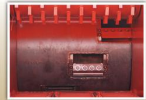
Štěpkovací buben osvědčený, stupňovitě uspořádaný štěpkovací buben, držáky nožů s tvrdokovovou úpravou.
