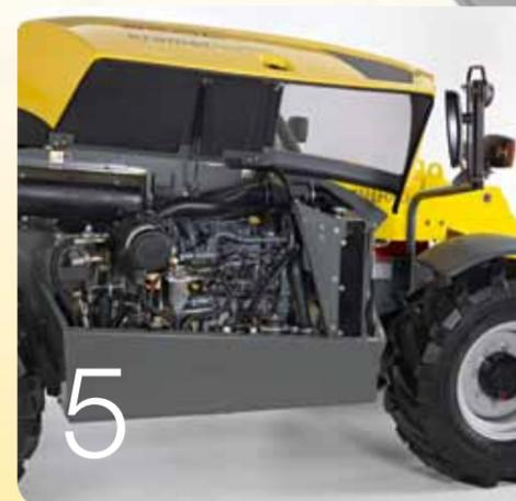
4 Die Motorhaube des 1245 ist abnehmbar. Das bringt freien Zugang zu den wichtigen Komponenten bei allen Wartungsarbeiten.
