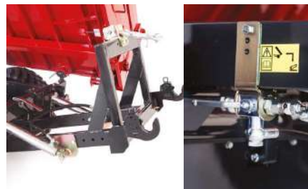
Odnímatelný zadní hydraulický nosič nářadí s tříbodovým připojením, vhodný pro přepravu zařízení, jako jsou jeřáby, lesnické nakladače, navijáky, štípače dřeva atd.
