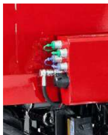
Třípákový hydraulický rozdělovač s regulátorem průtoku a rychlospojkami za a před kabinou. 3-Lever hydraulic distributor with flow regulator and quick couplings behind and in front of the cab
