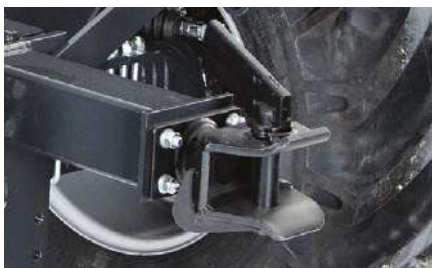
Zadní homologovaný tažný hák. Rear approved towing hook.
