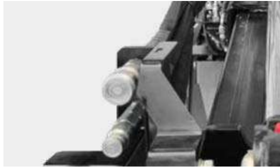
Přídavný hydraulický systém 1 D.A. 1 přídavný dvojitý okruh 115300201
