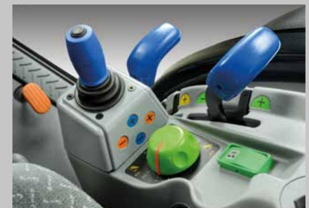
Die Bedienelemente für den Heckkraftheber und die hydraulischen Arbeitsgeräte: nah bei einander und leicht zu erreichen.
