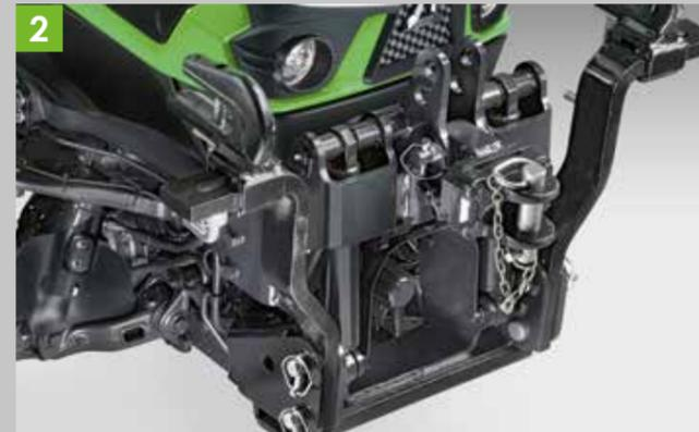
2 Fronthydraulik und Frontzapfwelle für effiziente Gerätekombinationen.
