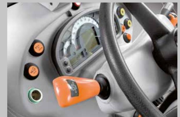
Powershuttle. Fahrtrichtungswechsel mit einem Handgriff.
