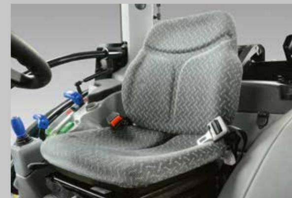
Verschiedene Sitzvarianten mit pneumatischer oder mechanischer Federung und unterschiedlichen Einstelloptionen stehen zur Auswahl.
