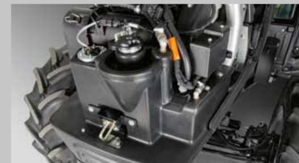
Der im Vorderachsbock integrierte Kraftstofftank ist auch bei geschlossener Motorhaube befüllbar, der Zusatztank befindet sich unterhalb des Fahrgestells.
