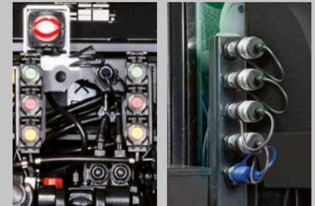
Bis zu sechs Zusatzsteuerventile im Heck- und Frontbereich.
