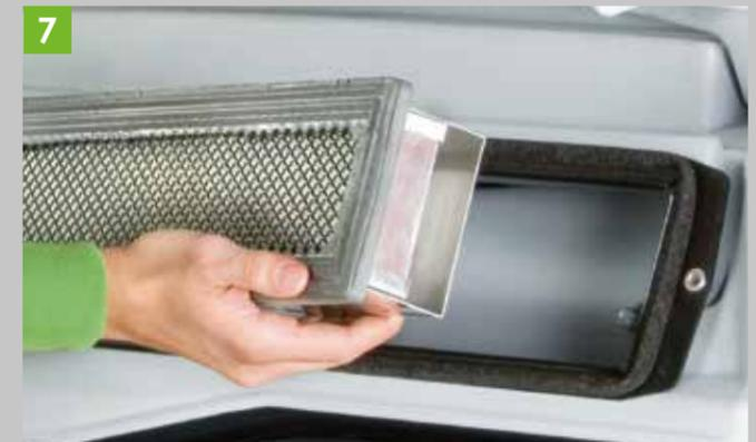
7 Kabinenluftfilter gegen Staub und Chemikalienbelastung. Immer saubere Luft in der Kabine.
