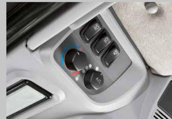
Die Bedienelemente für die Klimaanlage und die Arbeitsscheinwerfer befinden sich gut zugänglich im Dach.
