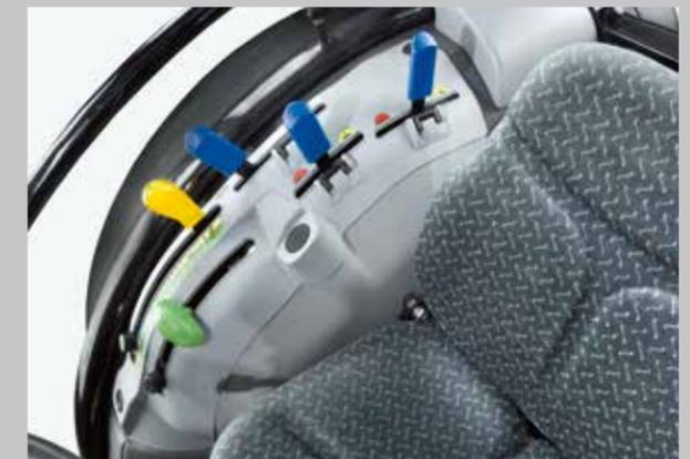
Bedienhebel für den mechanischen Heckkraftheber, funktionell und ergonomisch.
