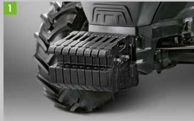
1 Unterschiedliche Frontgewichte für Arbeiten mit schweren Heckanbaugeräten.
