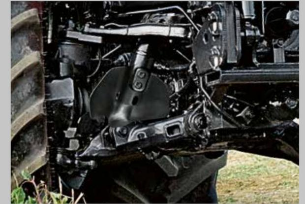
Unabhängige Federung der Vorderräder durch Einzerradaufhängung mit doppelten Querlenkern.
